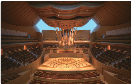
▲ 천장과 벽면에 반사판을 설치한 음악당
